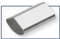
Neben den Hülsen für verdichtete Leiter in Rundform gibt es bei Sektorenleiter spezielle Hülsen in Sektorform. Es gibt hier 2 Varianten für 3-Leiter bzw. 4-Leiter Kabel. Diese Hülsen werden nach dem Abisolieren des Leiters aufgeschoben und mit einem speziellem Presseinsatz rundgedrückt. Danach wird der rundgedrückte Leiter inklusive rundgedrückter Sektorhülse in den
